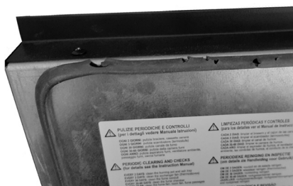
Fig. 24 - joint détérioré
