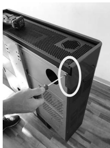
Fig. 46 - Fixer les vis
