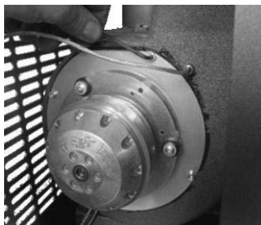
Fig. 65 - Nettoyage de l'aspirateur des fumées: phase 1
