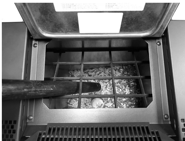
Fig. 34 - Nettoyage réservoir et vis sans fin
