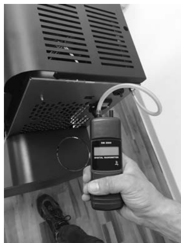
Fig. 59 - Connexion du pressostat numérique
