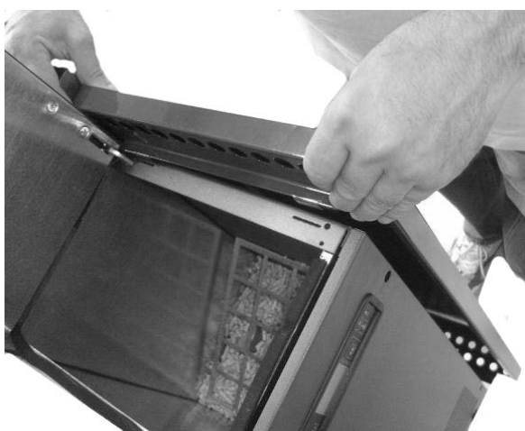
Fig. 40 - Insérer les panneaux
