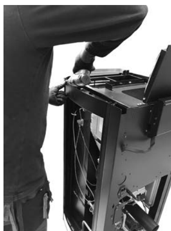
Fig. 52 - Borttagning kompenseringsenheden
