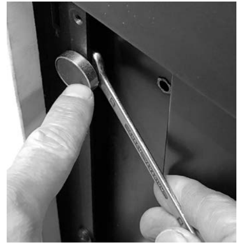
Fig. 41 - Justér magneten, og bloker med nøglen
