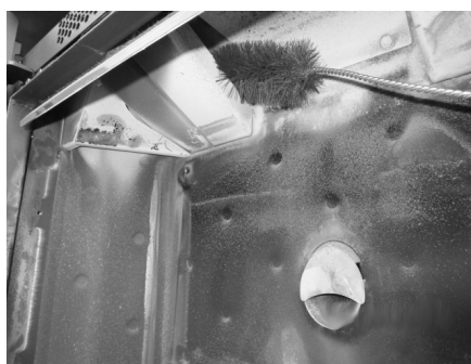
Fig. 40 - Reiniging met pijpenrager
