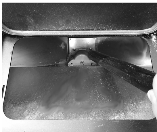
Fig. 35 - Reiniging van de voorraadbak
