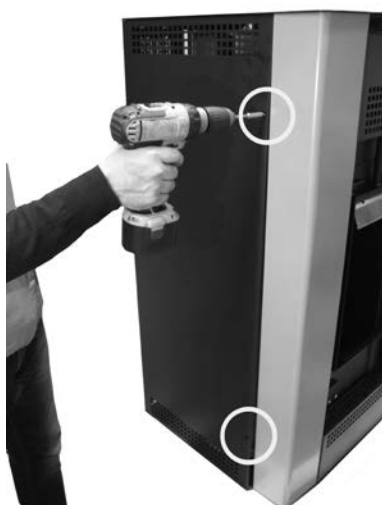
Fig. 93 - Remoção dos parafusos laterais
