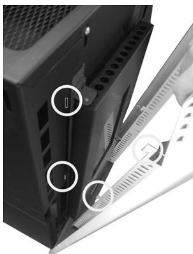
Fig. 30 - Montagem painel frontal
