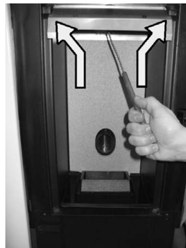
Fig. 98 - Limpar as duas condutas
