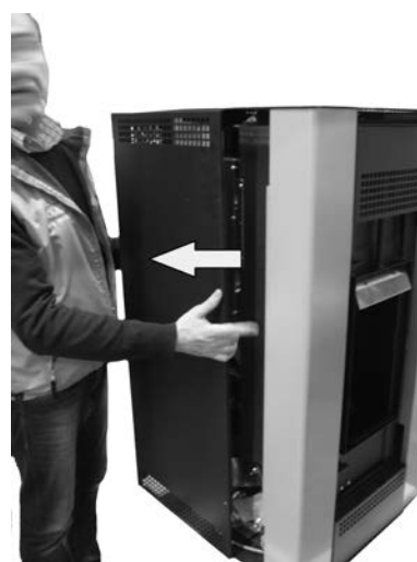
Fig. 95 - Remoção das paredes laterais
