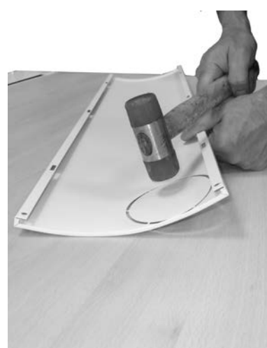
Fig. 38 - Abra o buraco (modelo Sfera 3 Plus)
