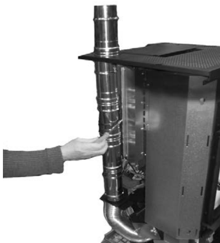
Fig. 56 - Posicionamento tubos superiores
