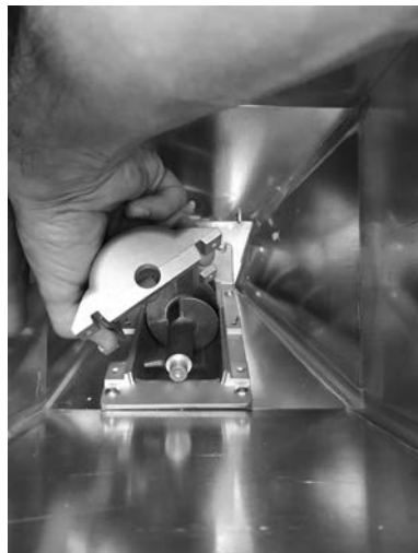
Fig. 71 - Remoção do casco
