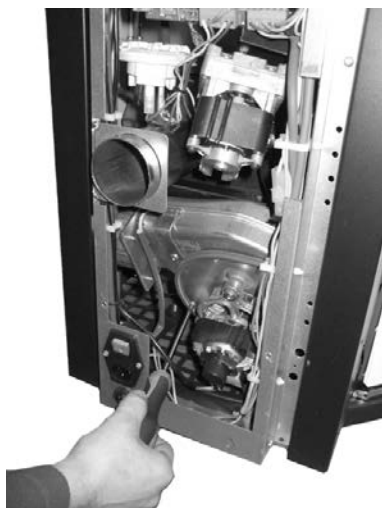
Fig. 104 - Limpeza do aspirador de fumos: fase 1
