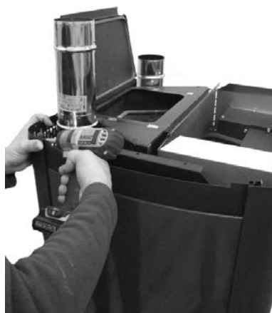
Fig. 91 - Remoção perfis curvos superiores
