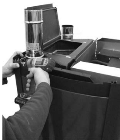
Fig. 47 - Reposicionamento perfis curvos superiores
