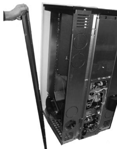
Fig. 77 - Remoção da lateral
