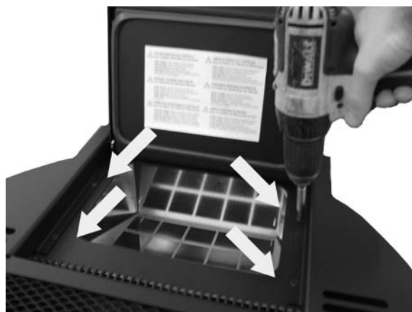
Fig. 82 - Remoção dos parafusos tampa 2
