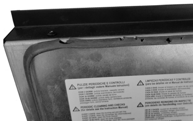
Fig. 21 - Junta deteriorada
