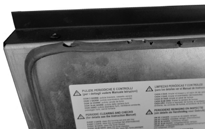
Fig. 21 - Verschlechterte Dichtung
