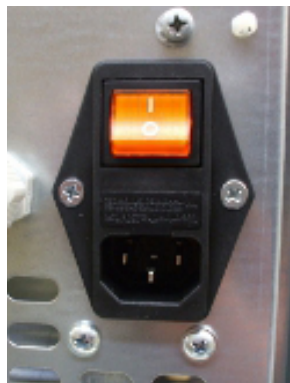
Fig. 23 - Prise électrique avec interrupteur général
