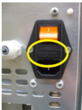
Fig. 51 - Sportellino con i fusibili da rimuovere
