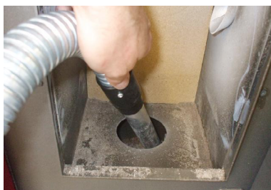
Fig. 40 - Nettoyage l'espace du brasero
