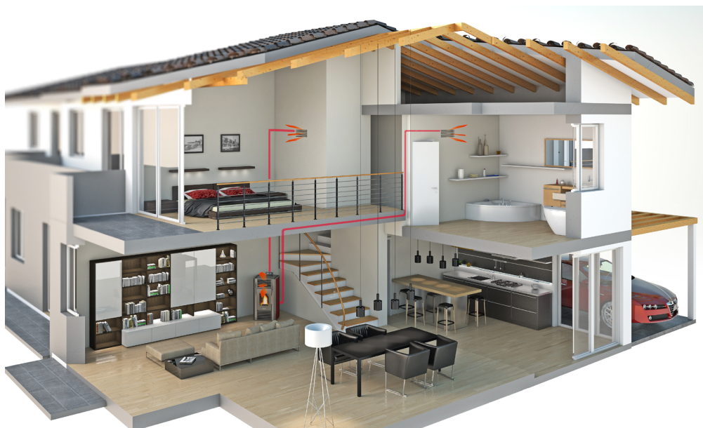
Fig. 31 - Exemple de canalisation
