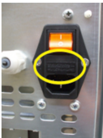
Fig. 51 - Hublot avec les fusibles à enlever
