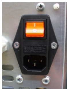
Fig. 23 - Presa elettrica con interruttore generale
