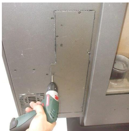
Fig. 43 - Rimozione pannello d'ispezione
