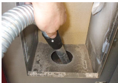
Fig. 40 - Pulizia vano braciere
