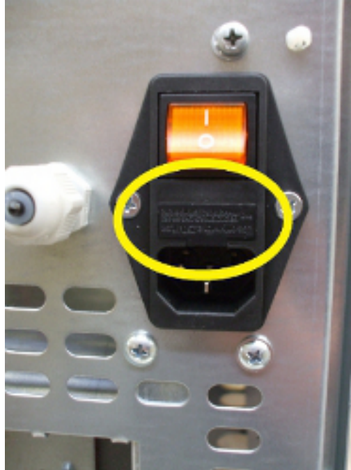
Fig. 50 - Porta com fusíveis a remover
