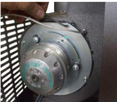
Fig. 46 - Limpeza do aspirador de fumos: fase 1
