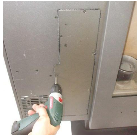
Fig. 42 - Remoção do painel de inspeção
