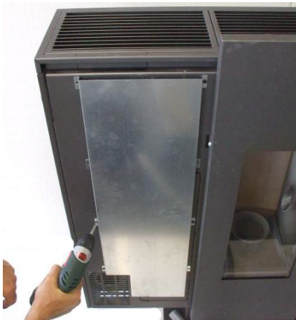
Fig. 41 - Remoção do painel de proteção do calor
