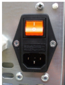
Fig. 23 - Tomada elétrica com interruptor geral
