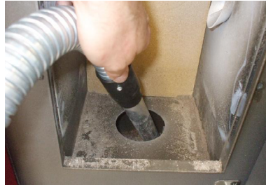
Fig. 38 - Limpeza do compartimento do braseiro
