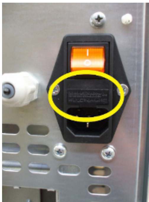
Fig. 50 - Hublot avec les fusibles à enlever
