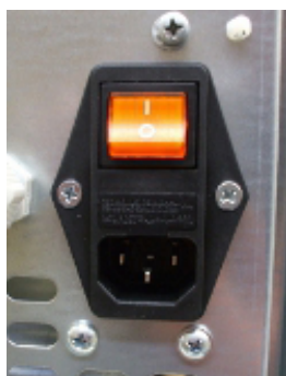
Fig. 23 - Presa elettrica con interruttore generale
