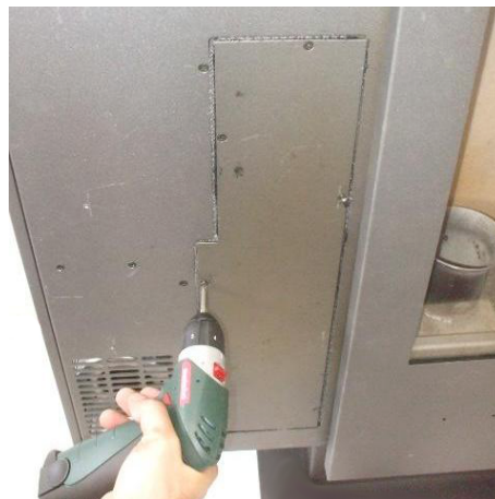
Fig. 42 - Rimozione pannello d'ispezione
