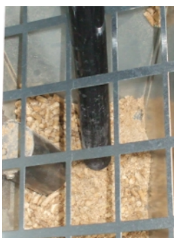
Fig. 40 - Pulizia serbatoio e coclea
