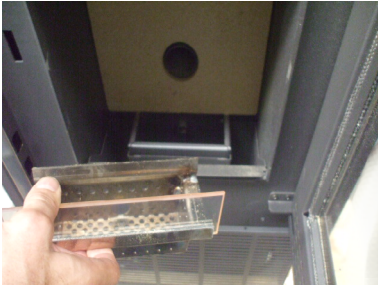
Fig. 40 - Remoção do braseiro
