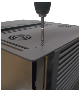
Fig. 57 - Remoção da cobertura
