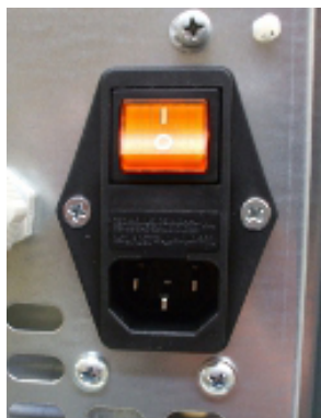
Fig. 29 - Tomada elétrica com interruptor geral
