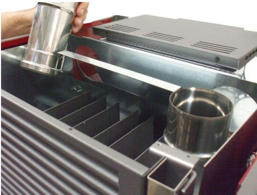
Fig. 31 - Posicionamiento superior de los tubos
