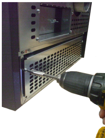
Fig. 55 - Extracción parrilla posterior
