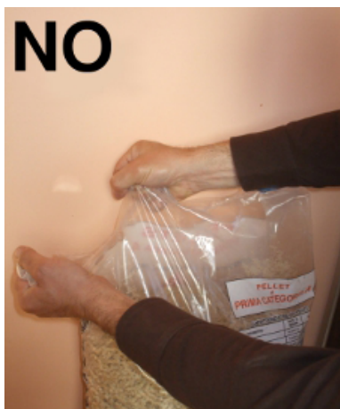
Fig. 37 - Abertura incorreta de saca de pellets
