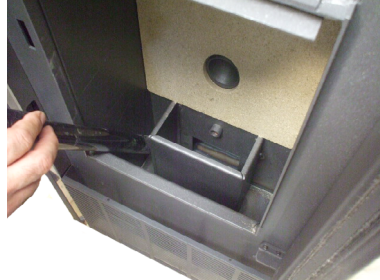
Fig. 44 - Limpieza alojamiento cajón de cenizas
