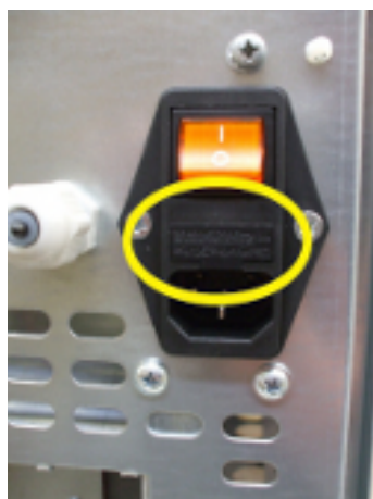
Fig. 62 - Porta com fusíveis a remover
