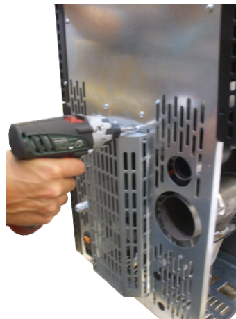
Fig. 66 - Enlever le couvercle arrière
