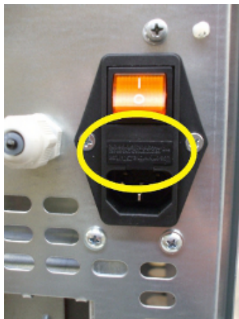
Fig. 65 - Hublot avec les fusibles à enlever
