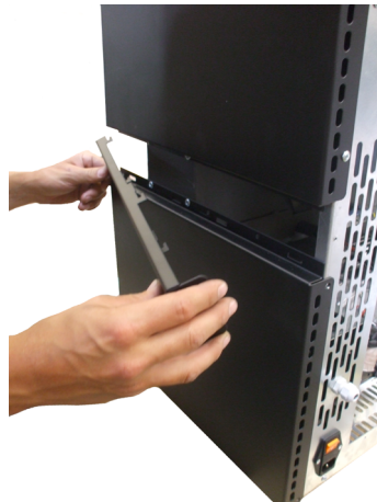
Fig. 60 - Enlèvement du panneau central
