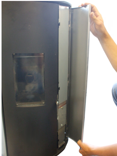
Fig. 51 - Enlever les panneaux
