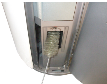
Fig. 54 - Nettoyage avec nettoie-pipes
