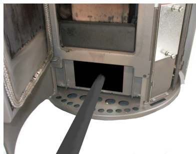
Fig. 43 - Nettoyage de la chambre des fumées
