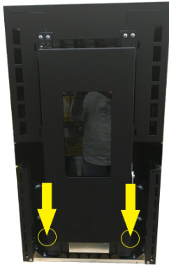
Fig. 21 - Retrait des vis
