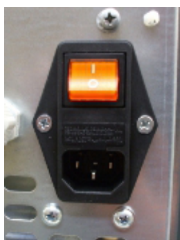
Fig. 26 - Presa elettrica con interruttore generale
