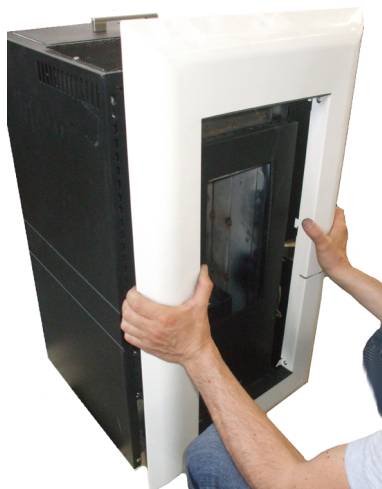
Fig. 55 - Rimozione pannello frontale
