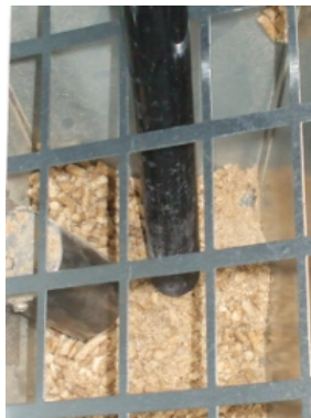
Fig. 27 - Limpeza do reservatório e da rosca sem fim
