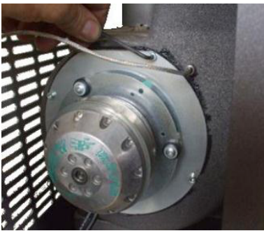
Fig. 32 - Limpeza do aspirador de fumos: fase 1
