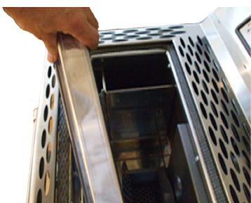
Fig. 21 - Remoção do plano de cozimento
