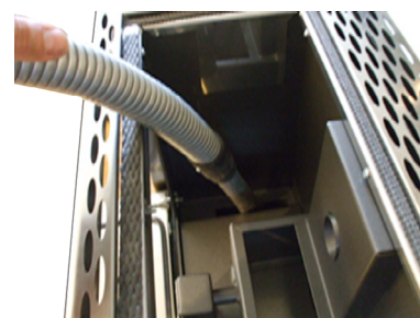
Fig. 23 - Limpeza da câmara de combustão
