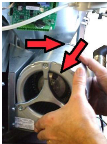
Fig. 62 - Remoção do ventilador
