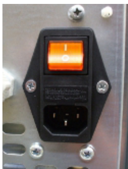
Fig. 43 - Tomada elétrica com interruptor geral
