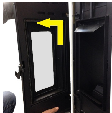
Fig. 72 - Remoção da porta
