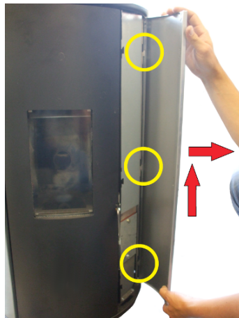
Fig. 66 - Sfera 3 / Sfera 3 Plus: odczepić panele boczne
