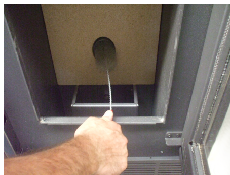
Fig. 59 - Czyszczenie szczotką do rur
