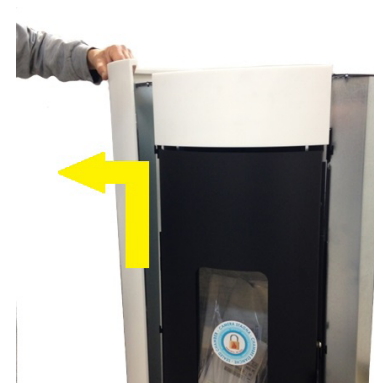
Fig. 75 - Usuwanie ścianek bocznych
