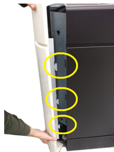
Fig. 27 - Mocowanie do pieca
