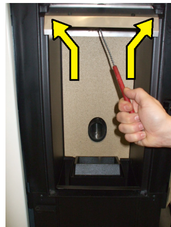
Fig. 78 - Wyczyścić obydwie przewody
