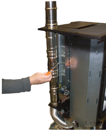
Fig. 45 - Układanie rur do górnego układu kanałowego
