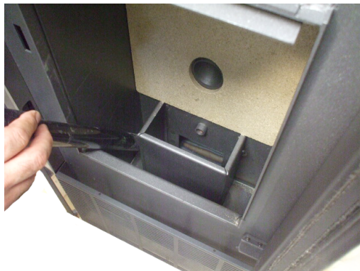
Fig. 58 - Czyszczenie miejsca na ruszt paleniskowy
