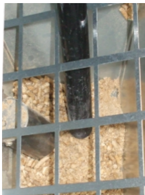
Fig. 60 - Czyszczenie zbiornika i ślimaka
