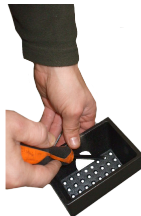
Fig. 57 - Czyszczenie rusztu paleniskowego
