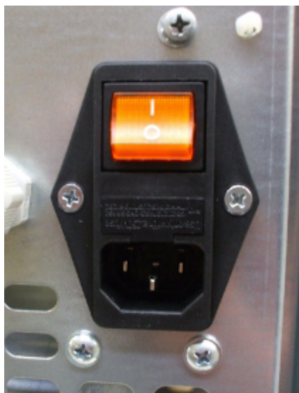
Fig. 19 - Presa elettrica con interruttore generale
