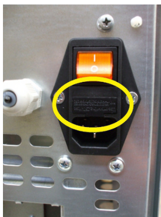
Fig. 42 - Trappe avec les fusibles à changer
