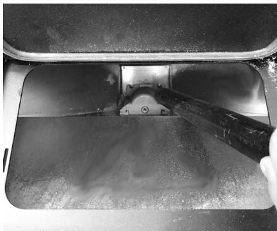
Fig. 22 - Limpieza depósito y coclea
