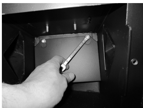
Fig. 37 - Rimozione viti
