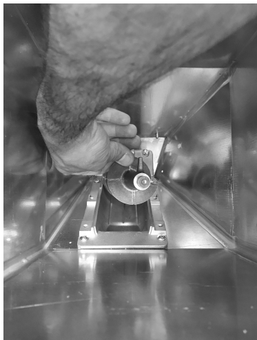
Fig. 30 - Rimozione spirale
