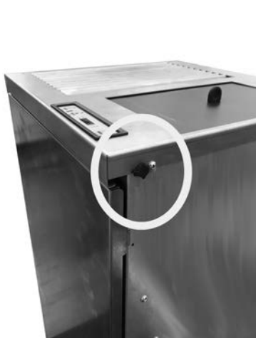
Fig. 60 - Αφαίρεση καπακιού
