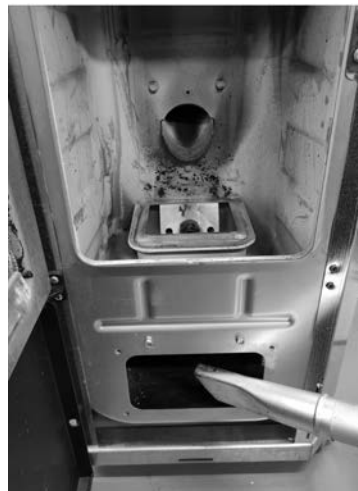
Fig. 70 - Κάντε αναρρόφηση της τέφρας
