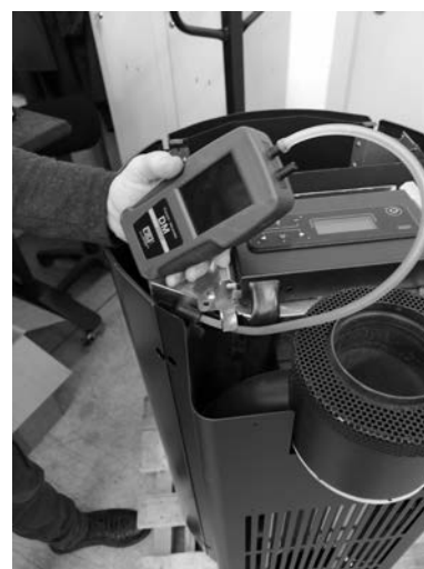
Fig. 62 - Σύνδεση ψηφιακού διακόπτη πίεσης
