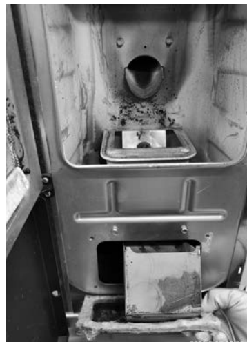
Fig. 68 - επιθεώρησης Αφαιρέστε καπάκι το
