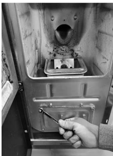
Fig. 67 - Αφαιρέστε τις βίδες
