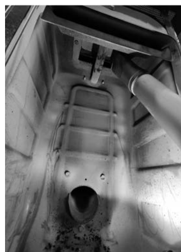
Fig. 72 - Κάντε αναρρόφηση της τέφρας
