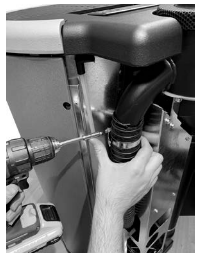
Fig. 54 - Βγάλτε τον εύκαμπτο σωλήνα
