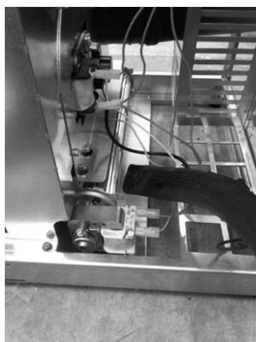
Fig. 73 - Καθαρισμός ανεμιστήρα δωματίου
