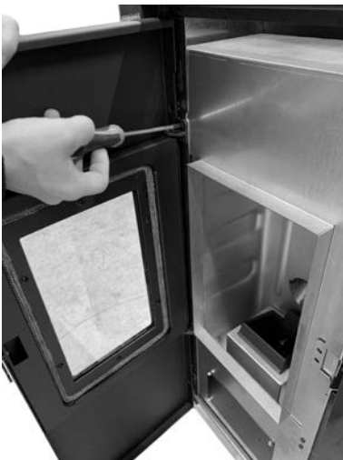
Fig. 24 - Αφαίρεση των βιδών
