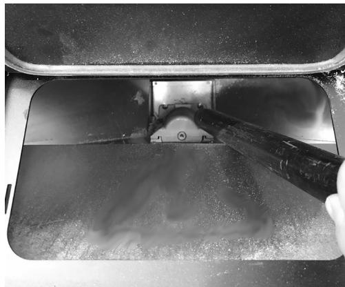
Fig. 17 - Limpeza do reservatório
