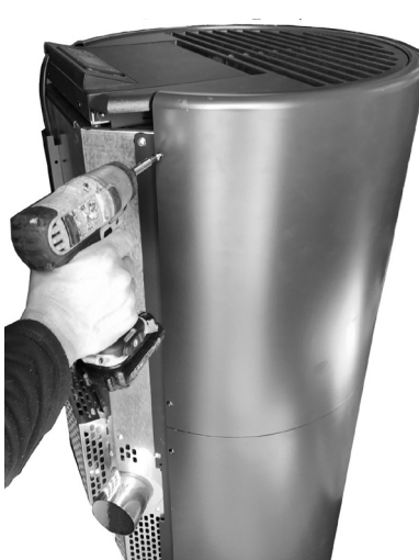
Fig. 66 - Die hinteren Schrauben entfernen.
