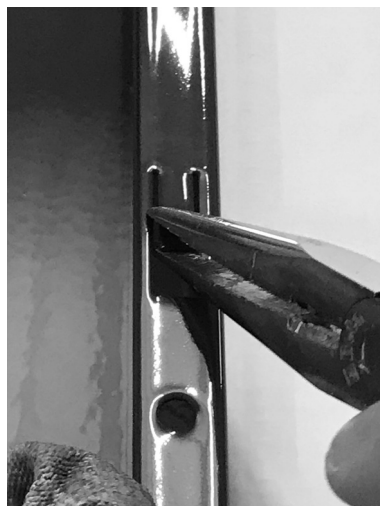
Fig. 45 - Biegen der kleinen Zungen nach außen
