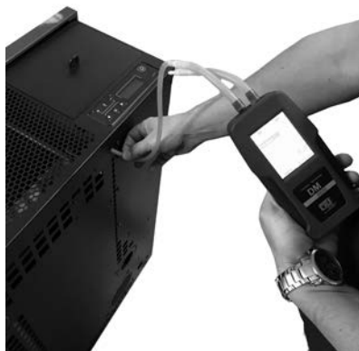
Fig. 62 - Digitalen Druckschalter anschließen
