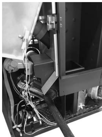
Fig. 69 - Reinigung Raumventilator
