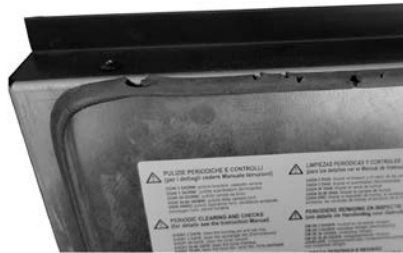
Fig. 23 - Junta deteriorada
