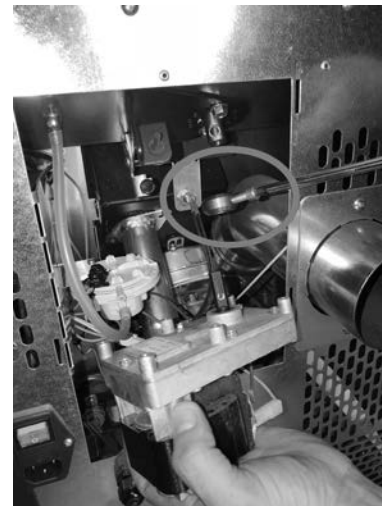
Fig. 90 - Verwijdering van de reductiemotor
