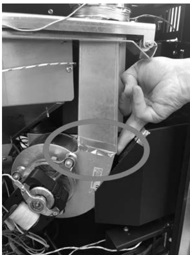
Fig. 46 - Met aluminium plakband verzegelen
