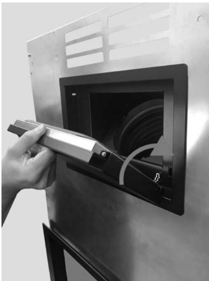
Fig. 68 - Plaats de deur in de laadklep
