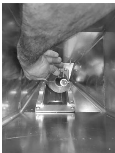
Fig. 91 - Verwijdering spiraal
