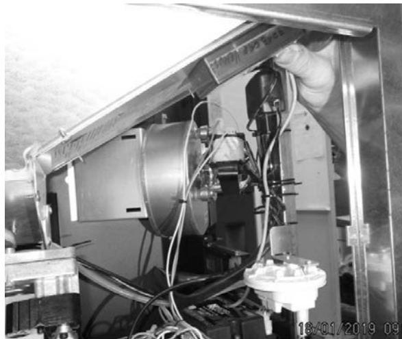
Fig. 87 - Bevestiging WI-FI-module
