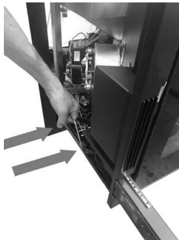
Fig. 23 - Verwijdering machineromp
