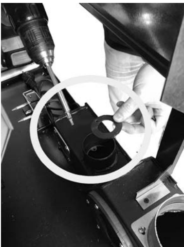
Fig. 75 - Verwijder de ring
