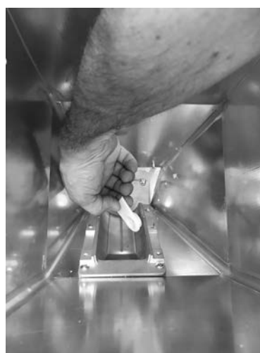
Fig. 92 - Verwijdering lager
