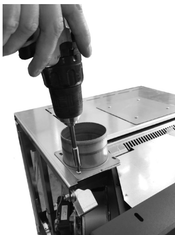
Fig. 47 - Fissare il raccordo
