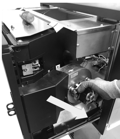
Fig. 96 - Rimuovere ventilatore
