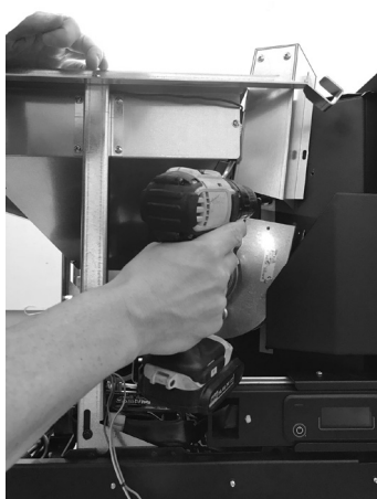
Fig. 44 - Fissare ventilatore
