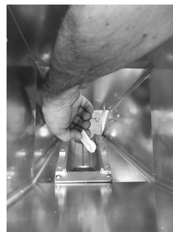
Fig. 92 - Rimozione cuscinetto
