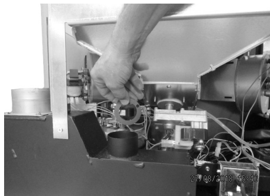
Fig. 29 - Rimozione anello 2
