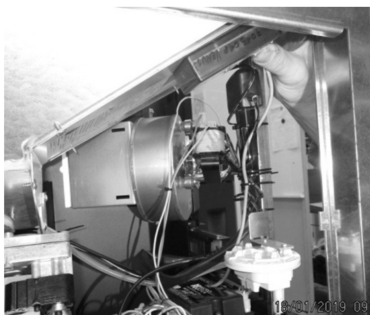
Fig. 87 - Fissaggio modulo WI-FI
