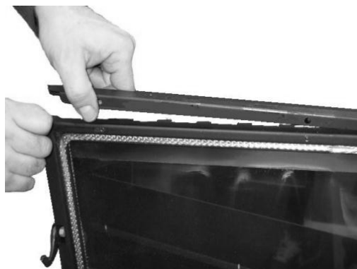
Fig. 101 - Rimozione profili porta
