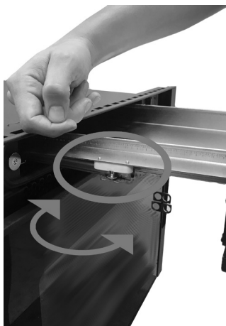
Fig. 56 - Regolazione per il centraggio
