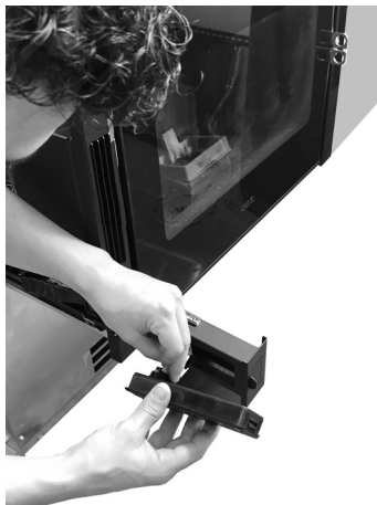
Fig. 79 - Rimuovere cavo flat
