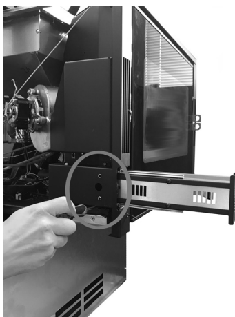
Fig. 82 - Fissare viti
