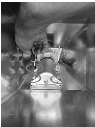
Fig. 35 - Retrait des vis
