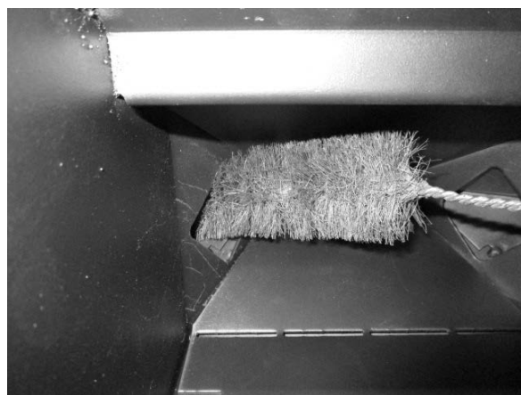
Fig. 52 - Nettoyage avec un goupillon 4
