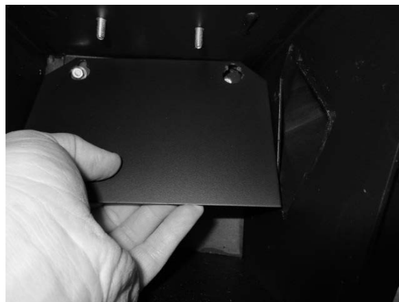
Fig. 46 - Retrait du déviateur de fumées
