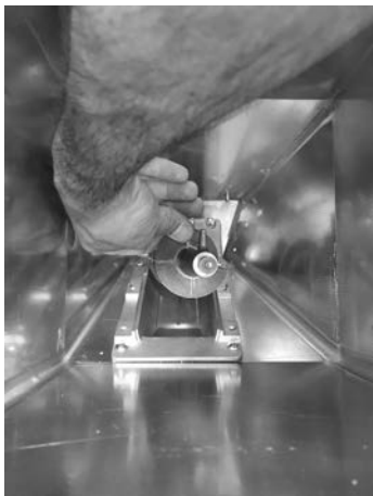
Fig. 38 - Retrait des spirales
