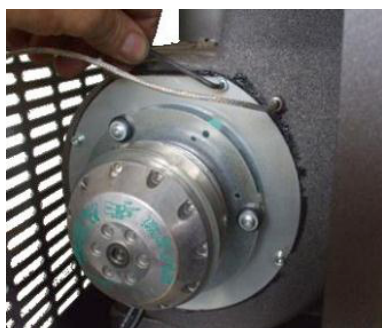
Fig. 46 - Reiniging rookgassenafzuiger: fase 1
