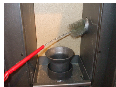
Fig. 39 - Reiniging met flessenwisser
