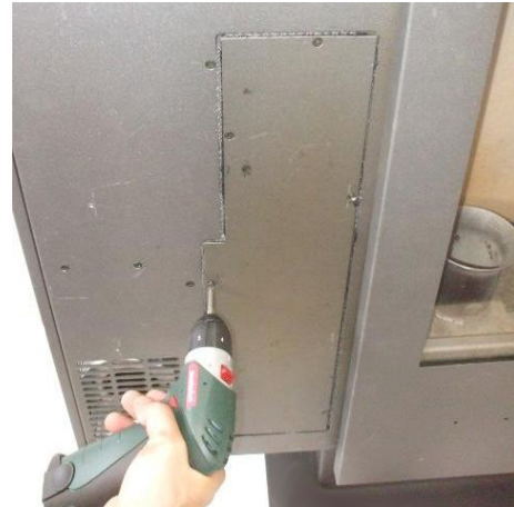
Fig. 42 - Verwijdering van het inspectiepaneel
