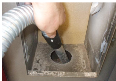
Fig. 38 - Reiniging ruimte vuurpot
