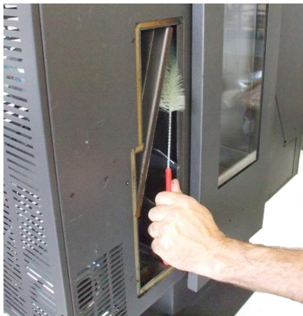
Fig. 43 - Reiniging met flessenwisser
