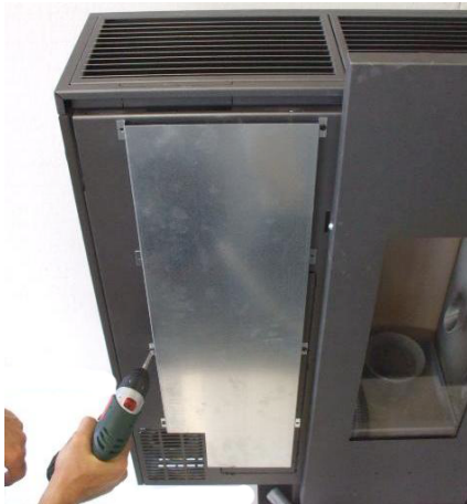
Fig. 41 - Verwijdering van het warmteschild
