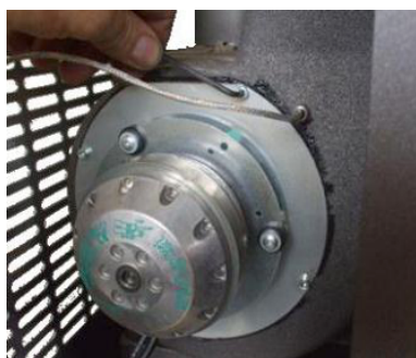
Fig. 50 - Nettoyage de l'aspirateur des fumées: phase 1
