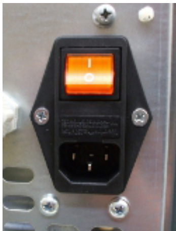
Fig. 29 - Presa elettrica con interruttore generale
