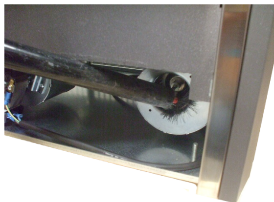
Fig. 56 - Nettoyage de le ventilateur ambiant
