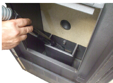
Fig. 43 - Nettoyage l'espace du brasero
