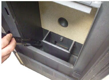
Fig. 44 - Pulizia vano cassetto cenere
