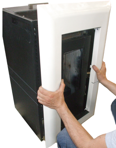
Fig. 55 - Odstranjevanje sprednjega panela
