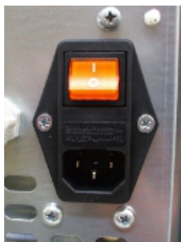
Fig. 26 - Ηλεκτρική πρίζα με γενικό διακόπτη
