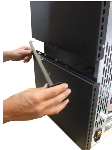
Fig. 58 - Αφαίρεση Πλάκας εκτροπής
