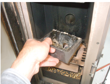
Fig. 33 - Εξαγωγή δοχείου καύσεως
