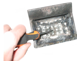
Fig. 35 - Καθαρισμός δοχείου καύσεως
