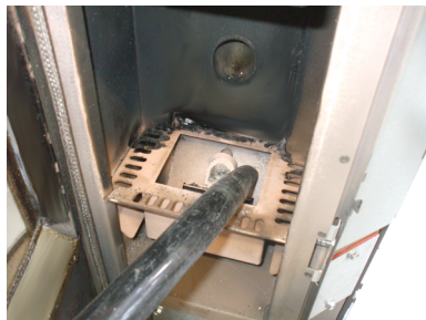
Fig. 36 - Καθαρισμός εσωτερικού μέρους δοχείου καύσεως
