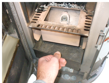
Fig. 34 - Εξαγωγή δοχείου συλλογής στάχτης
