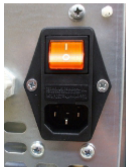
Fig. 26 - Tomada elétrica com interruptor geral
