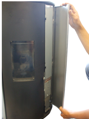
Fig. 49 - Remoção dos painéis
