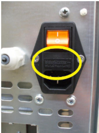
Fig. 63 - Porta com fusíveis a remover
