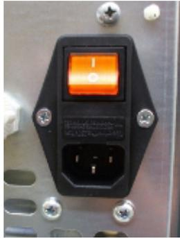
Fig. 26 - Toma de corriente con interruptor general
