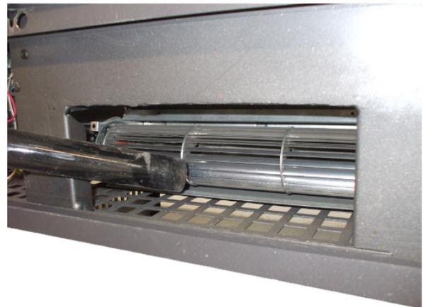
Fig. 47 - Limpieza ventilador ambiente
