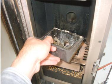
Fig. 33 - Extracción del brasero
