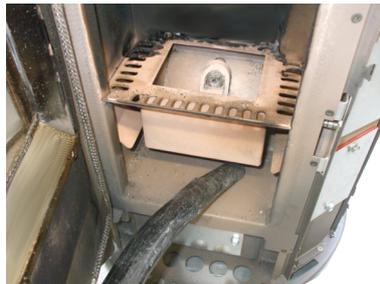
Fig. 37 - Limpieza alojamiento cajón de cenizas
