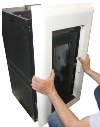
Fig. 21 - Ensamblaje marco
