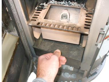
Fig. 34 - Extracción del cajón de cenizas
