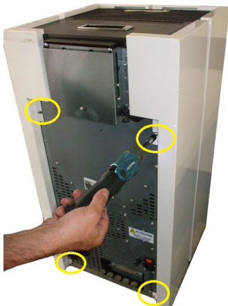
Fig. 18 - Remover os parafusos
