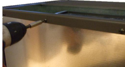
Fig. 14 - Remoção dos parafusos na parte traseira
