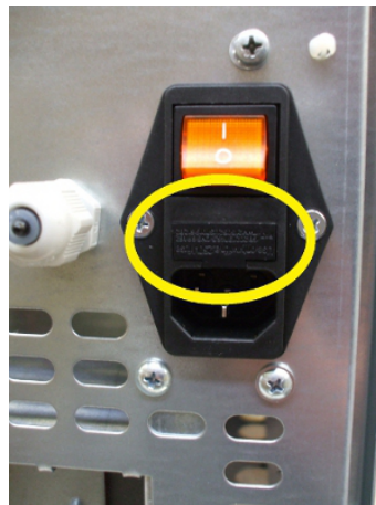
Fig. 48 - Porta com fusíveis a remover
