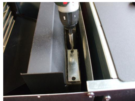
Fig. 44 - Remoção das tampas
