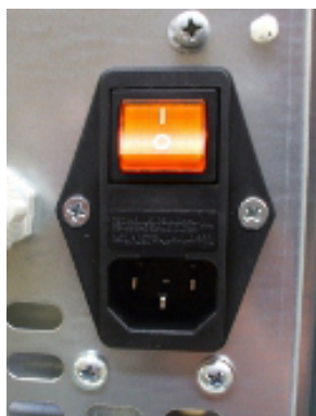
Fig. 24 - Tomada elétrica com interruptor geral
