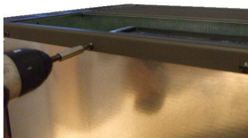
Fig. 14 - Extacción de los tornillos posteriores
