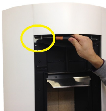
Fig. 73 - Den øvre skrues løsning
