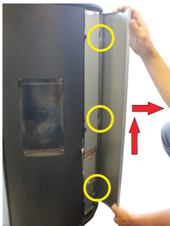
Fig. 28 - Monterning af paneler
