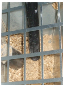
Fig. 60 - Rengøring af magasin og snegl
