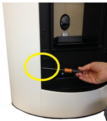
Fig. 74 - Den nedre skrues løsning
