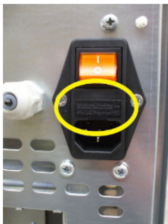
Fig. 88 - Dæksel med sikringerne, der skal fjernes
