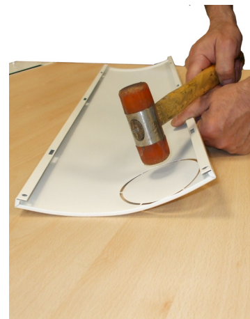
Fig. 30 - Åben hullet (Sfera 3 Plus model)
