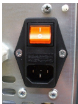
Fig. 43 - Presa elettrica con interruttore generale
