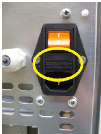
Fig. 88 - Sportellino con i fusibili da rimuovere
