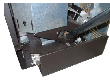
Fig. 81 - Pulizia camera fumi
