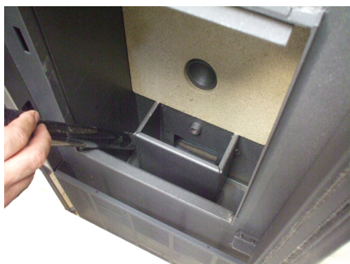
Fig. 58 - Pulizia vano braciere
