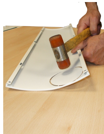
Fig. 30 - Apertura foro (modello Sfera 3 Plus)
