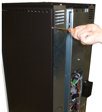
Fig. 62 - Rimozione vite posteriore
