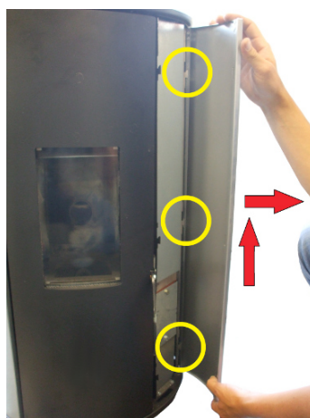
Fig. 66 - Sfera 3 / Sfera 3 Plus: sganciare i pannelli laterali
