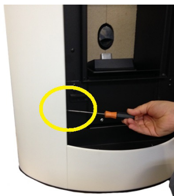
Fig. 74 - Allentare vite inferiore
