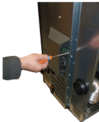
Fig. 89 - Rimozione carter posteriore
