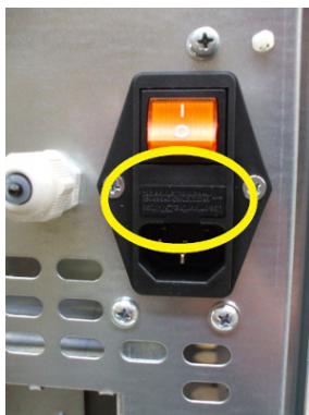
Fig. 42 - Dæksel med sikringerne, der skal fjernes
