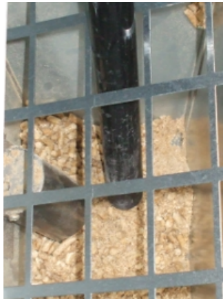
Fig. 31 - Rengøring af magasin og snegl
