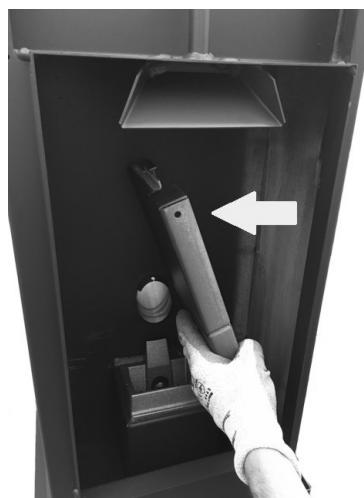
Fig. 44 - Usuwanie prawej kłapy
