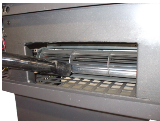
Fig. 43 - Nettoyage de le ventilateur ambiant
