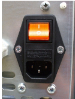
Fig. 24 - Prise électrique avec interrupteur général
