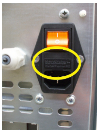
Fig. 48 - Hublot avec les fusibles à enlever
