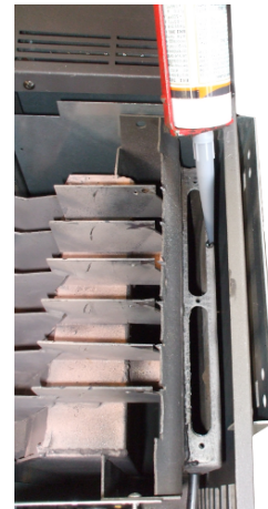
Fig. 47 - Application de la silicon
