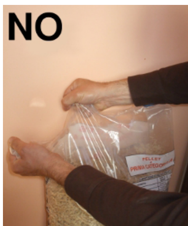
Fig. 27 - Ouverture incorrecte du sac des granulés
