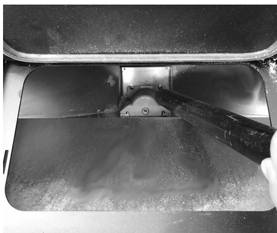
Fig. 30 - Czyszczenie zbiornika
