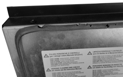
Fig. 23 - Zniszczona uszczelka
