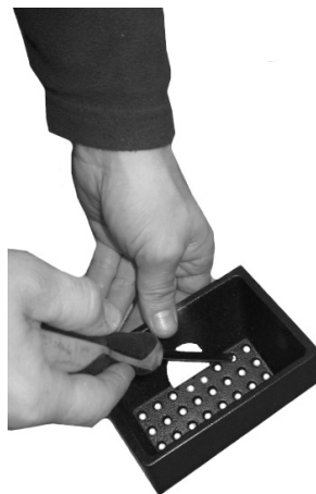
Fig. 32 - Czyszczenie rusztu paleniskowego
