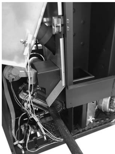
Fig. 79 - Limpieza ventilador ambiente
