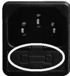
Fig. 82 - Ventanilla con los fusibles de remover
