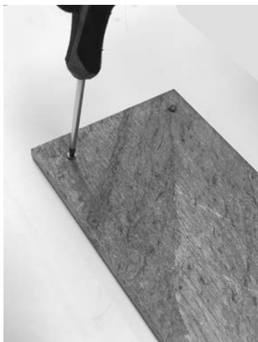
Fig. 40 - Apretar los tornillos
