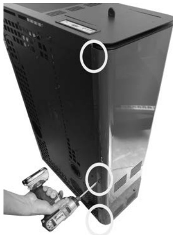
Fig. 58 - Extracción de los tornillos 4
