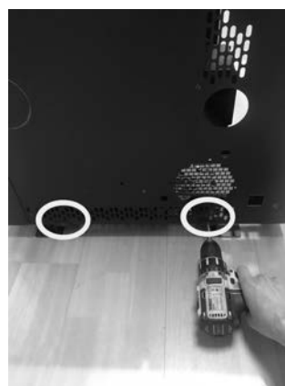
Fig. 65 - Fije los tornillos
