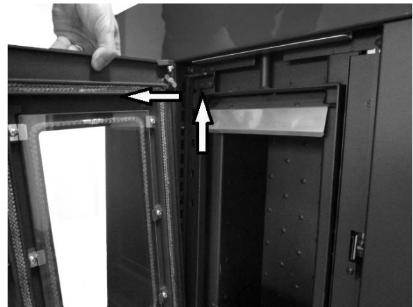
Fig. 31 - Desmontaje de la puerta
