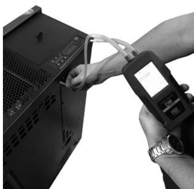
Fig. 72 - Conexión de presostato digital
