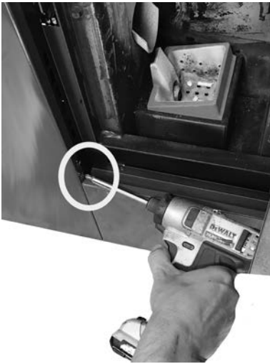
Fig. 54 - Extracción de los tornillos 1
