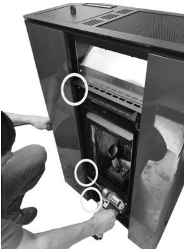
Fig. 57 - Extracción de los tornillos 3
