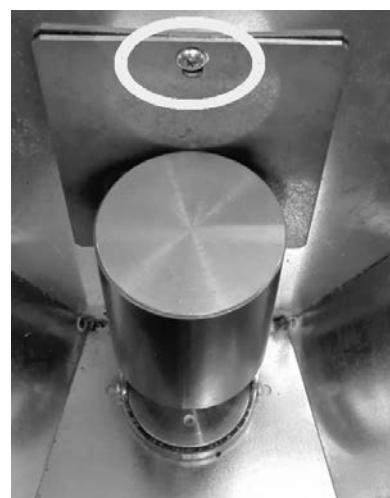
Fig. 84 - Retirada del tornillo
