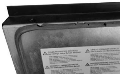
Fig. 22 - Guarnizione deteriorata
