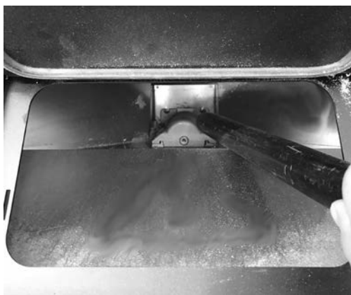
Fig. 35 - Limpeza do reservatório e da rosca sem fim
