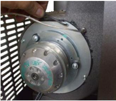
Fig. 47 - Limpieza del aspirador de humos: fase 1
