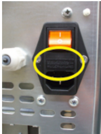
Fig. 51 - Porta com fusíveis a remover
