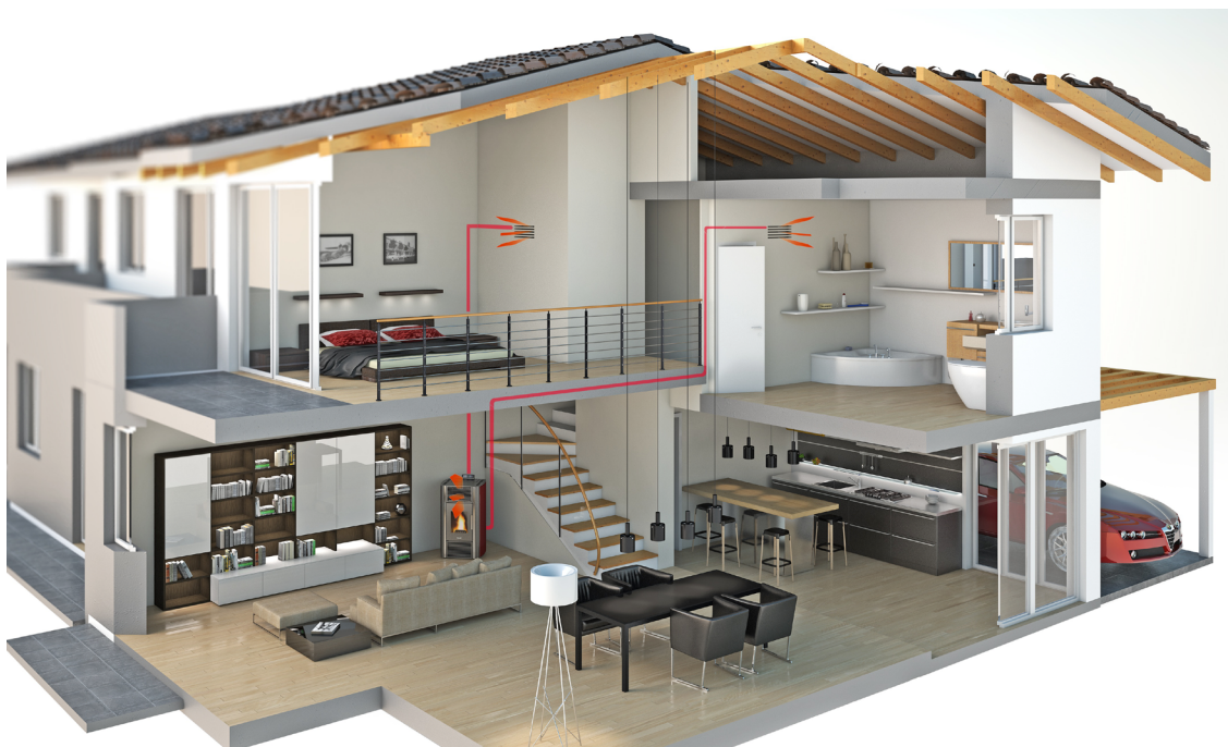
Fig. 31 - Ejemplo de canalización
