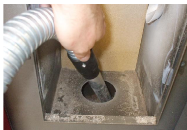
Fig. 40 - Limpieza alojamiento brasero
