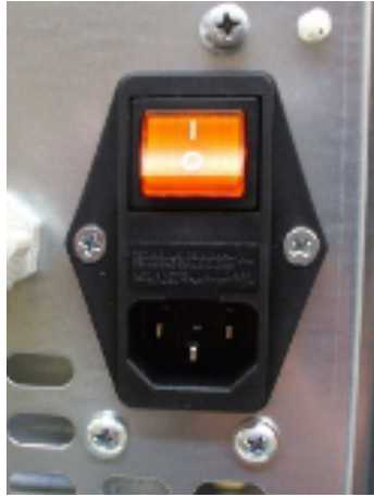
Fig. 23 - Tomada elétrica com interruptor geral
