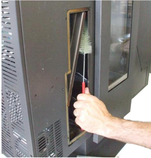
Fig. 44 - Limpieza con escobilla
