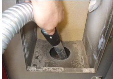
Fig. 40 - Limpeza do compartimento do braseiro
