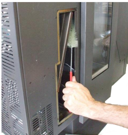
Fig. 44 - Reiniging met flessenwisser
