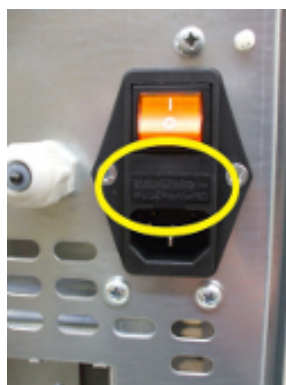
Fig. 51 - Deurtje met te verwijderen zekeringen
