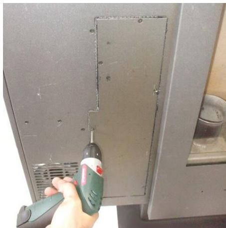
Fig. 43 - Verwijdering van het warmteschild
