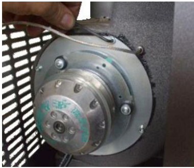
Fig. 47 - Reiniging rookgassenafzuiger: fase 1
