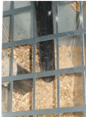
Fig. 42 - Reiniging van de voorraadbak en transportschroef
