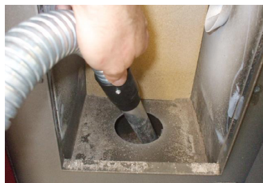
Fig. 40 - Reiniging ruimte vuurpot
