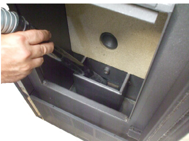
Fig. 43 - Καθαρισμός εσωτερικού μέρους δοχείου καύσεως
