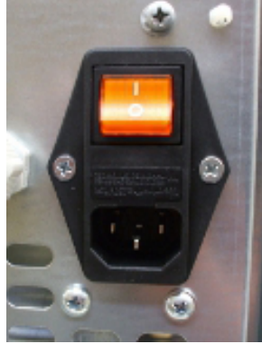
Fig. 29 - Ηλεκτρική πρίζα με γενικό διακόπτη
