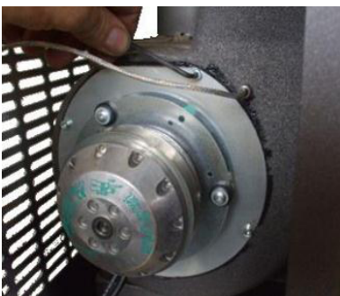
Fig. 40 - Καθαρισμό ανεμιστήρα καυσαερίων : Φάση 1
