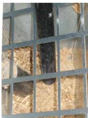
Fig. 36 - Reiniging van de voorraadbak en transportschroef
