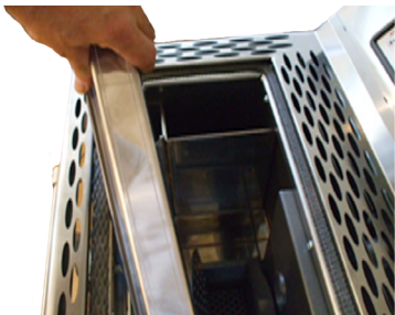
Fig. 20 - Remoção do plano de cozimento
