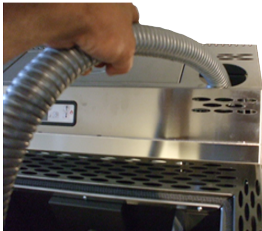
Fig. 30 - Limpeza do canal de fumo
