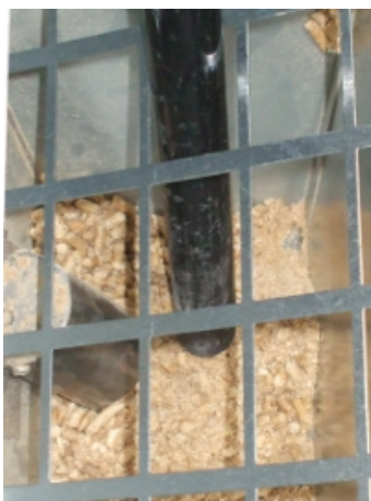
Fig. 26 - Limpeza do reservatório e da rosca sem fim
