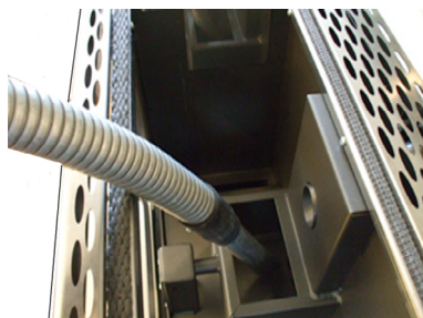
Fig. 24 - Limpeza do compartimento do braseiro
