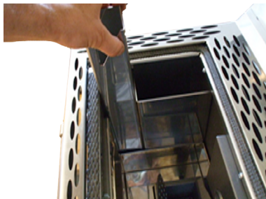
Fig. 21 - Remoção dos componentes internos
